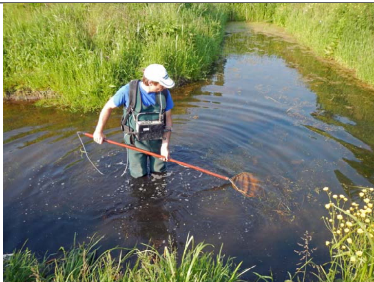
Figuur 1.2 Visinventarisatie doormiddel van electrovisserij met een DEKA 3000.
